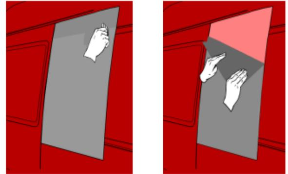
Note: La pose sur ce type de surface doit être effectuée de manière systématique; l'approche section par section est la meilleure option. Tout écart de cette séquence de pose peut entraîner des plis, qui sont parfois difficiles, voire impossibles à supprimer.
