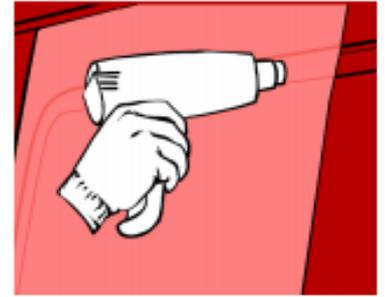
7. À présent, commencez à étirer le matériau dans l'ondulation, en commençant par la partie la plus profonde de l'ondulation (la partie où le matériau aura le plus besoin d'étirement, comme un coin). Assurez-vous que le matériau est chauffé pour rester dans la plage de température comprise entre 40° et 50°C.
