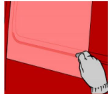
9. Lorsque toutes les parties les plus profondes de l'ondulation ont été posées, vous pouvez poursuivre avec le reste de l'ondulation. Là encore, assurez-vous que le matériau est chauffé à la température requise de 40° à 50°C, et avancez tout le long de l'ondulation.
