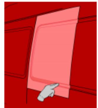
11. Vérifiez la pose pour détecter les bulles restantes. S'il reste encore de petites bulles d'air, celles-ci peuvent facilement être enlevées. Faites une petite piqûre, chauffez le film (40 à 50°C) et expulsez l'air.
