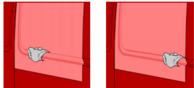
10. Maintenant que tous les bords sont correctement posés, il est nécessaire de poser le matériau au centre de l'ondulation. Ce faisant, assurez-vous qu'il n'y a pas d'air coincé sous le film, en laissant toujours une ouverture pour laisser l'air s'échapper.
