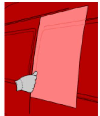
5. À présent, la pose du matériau dans l'ondulation peut commencer. Afin d'être en mesure de le faire sans former de plis, il est conseillé d'humidifier le gant de pose AD, en utilisant un mélange d'eau et de savon.
